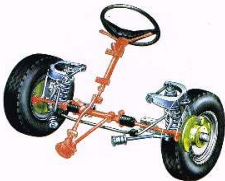
Ein weiteres Beispiel für den hohen technischen Vorsprung der Volkswagen Busse und Kombis ist die vorbildliche Doppelquerlenker Vorderachse mit spurstabilisierendem Lenkrollradius.
