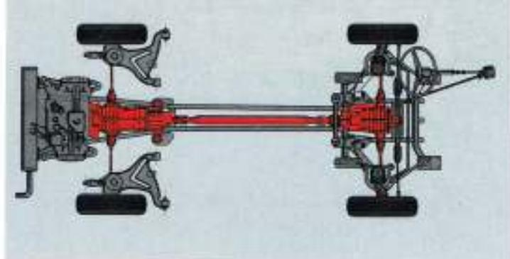
Die synchro-Technik regelt, ganz im Gegensatz zu herkömmlichen Allradfahrzeugen, den zusätzlichen Antrieb der Vorderräder im Bedarfsfall automatisch. Bereits minimalste Drehzahlunterschiede zwischen
