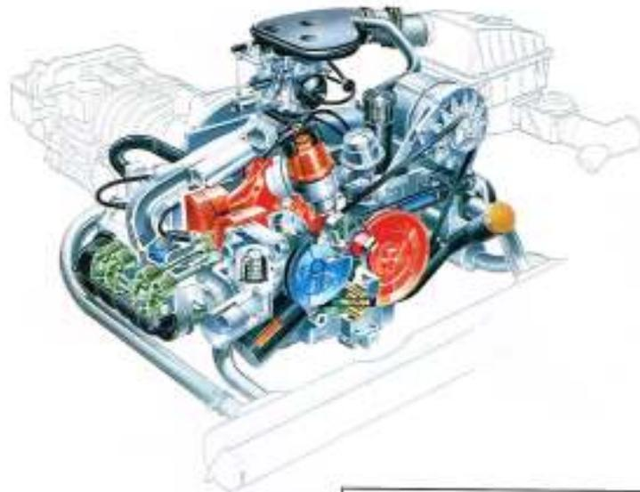
4-Zylinder-Ottomotor (wassergekühlter Boxermotor). Hubraum: 1913 cm<sup>3</sup>. Verdichtung: 8,6:1. Leistung: 44 kW (60 PS) bei 3.700/min. Größtes Drehmoment: 140 Nm bei 2.200/min.
