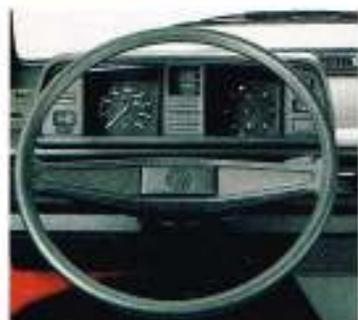
Noch ein Blick auf die Armaturentafel mit der regelbaren Instrumentenbeleuchtung.
