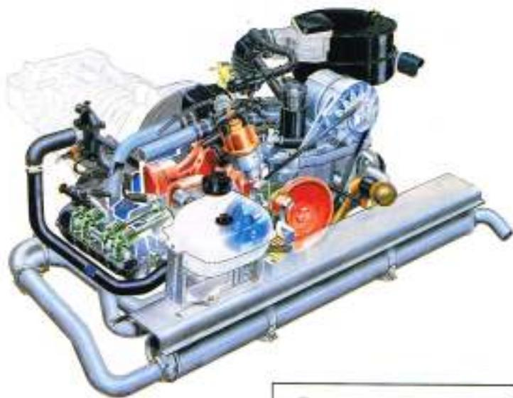
4-Zylinder-Ottomotor (wassergekühlter Boxermotor). Hubraum: 2109 cm<sup>3</sup>, Verdichtung: 10,5 : 1, Leistung: 82 kW (112 PS) bei 4.800/min. Größtes Drehmoment: 174 Nm bei 2.800/min. Mit Katalysator und Lambda-Sonde: Verdichtung 9,0 : 1, Leistung: 70 kW (95 PS) bei 4.800/min. Größtes Drehmoment: 160 Nm bei 2.500/min.
