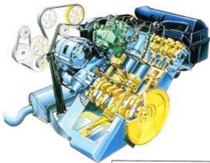
4-Zylinder-Dieselmotor. Hubraum: 1566 cm<sup>3</sup>, Verdichtung: 23,0 : 1, Leistung: 37 kW (50 PS) bei 4.200/min. Größtes Drehmoment: 103 Nm bei 2.000/min.
