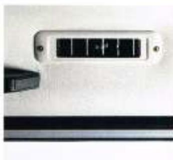
Für angenehmes Klima Bus sorgt das kombinierte Heizungs- und Frischluftsystem mit dreistufigem Gebläse. Durch die Lüftungskanäle und vier Düsen im Dachrahmen können Sie an jeden Platz im individuell dosierte Frischluft lenken.
