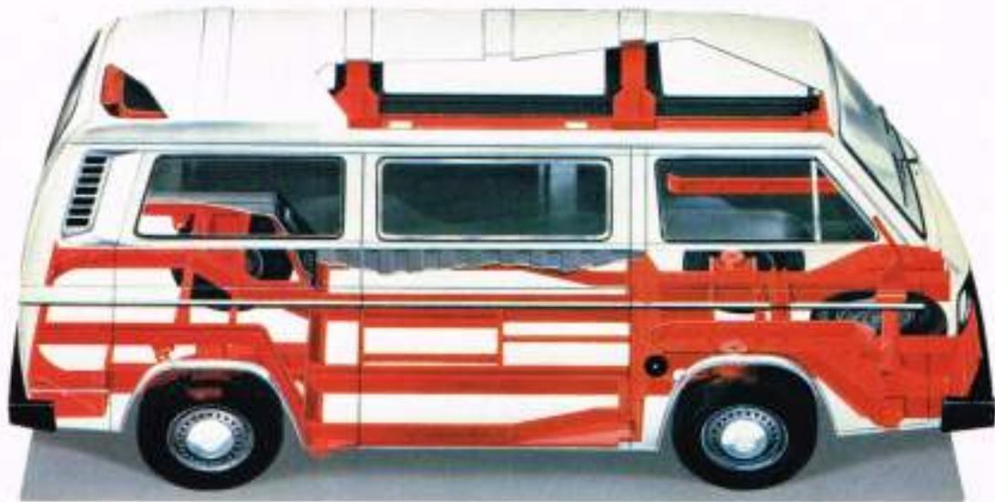
Zum aufwendigen Sicherheitssystem gehört die verformungssteife Rahmenkonstruktion der Bodengruppe ebenso wie der Gabelrahmen aus widerstandsfähigen Rahmenprofilen unter dem Fahrerhaus. Sie bewirken eine hohe passive Sicherheit. Aufprallenergie wird über
